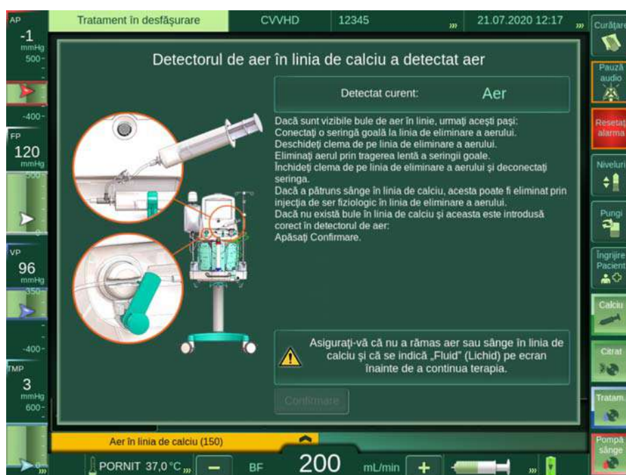
Imagina 8-26 Detectorul de aer în linia de calciu a detectat aer
