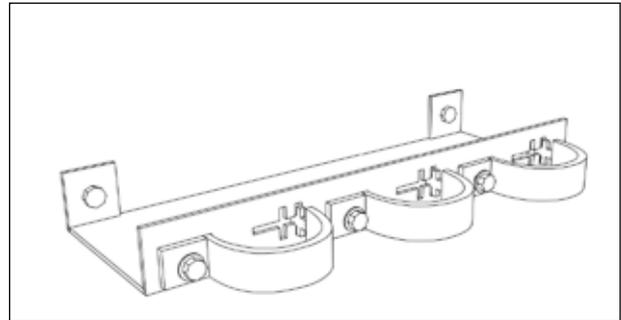
Рис. 4.44 Переднее соединение на ячейках с функциями защиты
