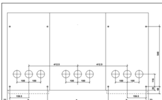
Рис. 4.26 Схема анкерного крепления **cgmcosmos-2Ip**, -1р высотой 1740 мм
