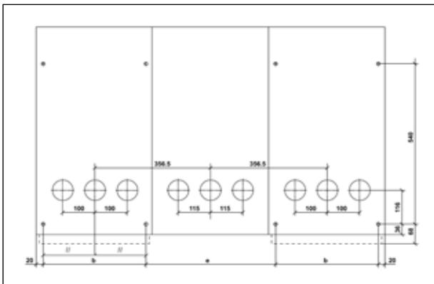
**Рис. 4.32** Схема анкерного крепления cgmcosmos-2lv высотой 1740 мм
