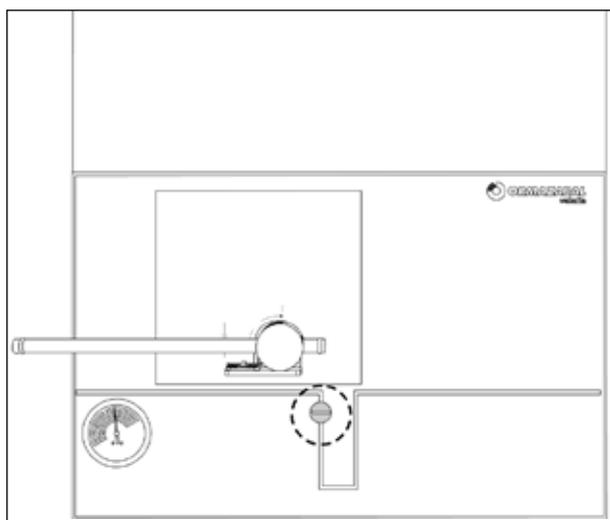
Рис. 5.22 Выключатель-разъединитель отключен
