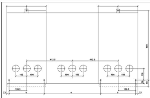
Рис. 4.25 Схема анкерного крепления **cgmcosmos-2Ip**, -1р высотой 1300 мм
