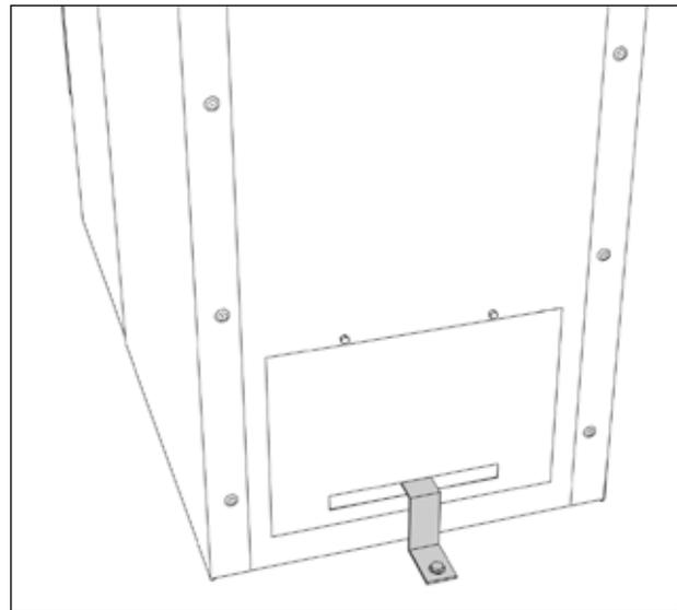
**Рис. 4.35** Ячейка с уголком в центральном положении
