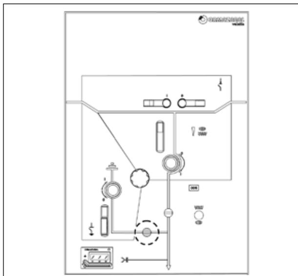
Рис. 5.100 Положение "заземлено"
