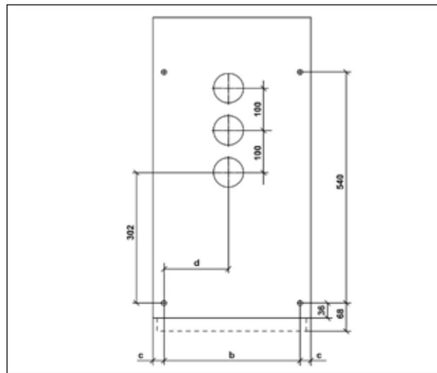
**Рис. 4.23** Схема анкерного крепления **cgmcosmos-rc** высотой 1740 мм
