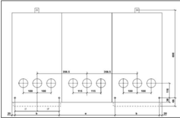
**Рис. 4.31** Схема анкерного крепления cgmcosmos-2lv высотой 1300 мм
