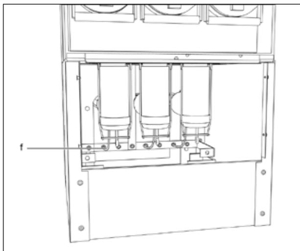
Рис. 4.50 Заднее подключение в модульных ячейках высотой до 1300 мм
