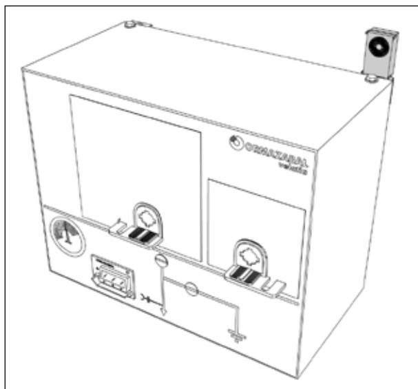
Рис. 7.2 Расположение устройства **ekor.sas** в блоке фидера **cgmcosmos**
