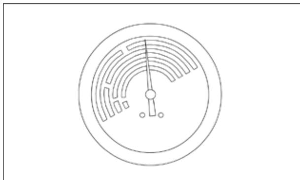
Рис. 5.1 Реле давления
