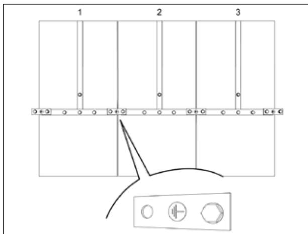
Рис. 4.38 Заземление оборудования
