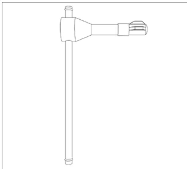
Рис. 5.68 Рычаг приводных механизмов В и ВМ
