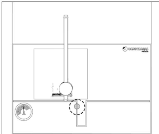
Рис. 5.20 Выключатель-разъединитель включен
