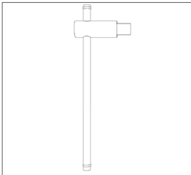
Рис. 5.69 Рычаг взвода пружин AV и RAV
