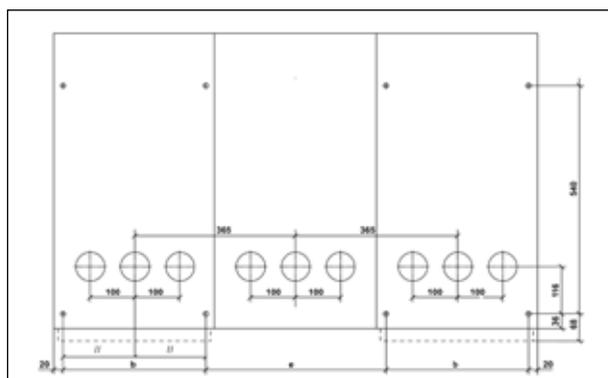
Рис. 4.30 Схема анкерного крепления **cgmcosmos-3I** высотой 1740 мм
