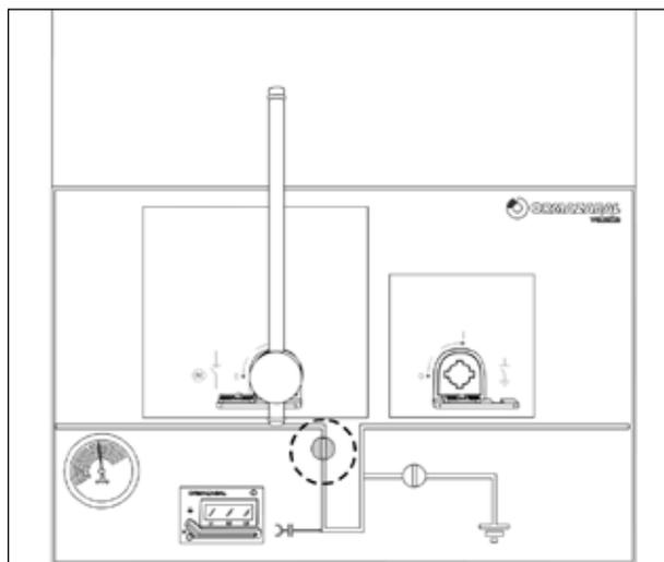
Рис. 5.28 Выключатель-разъединитель включен
