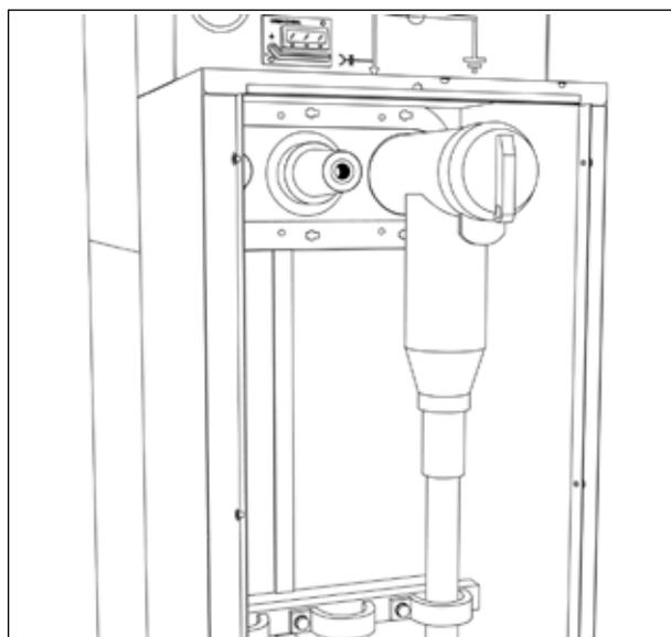
**Рис. 1.3** Кабельный отсек
