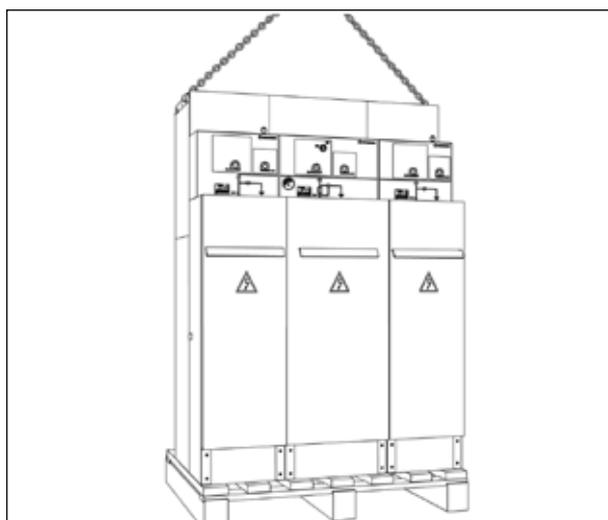
**Рис. 2.2** Подъем ячеек **cgmcosmos** с помощью цепей
