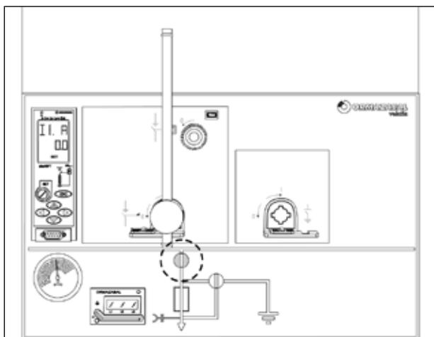
Рис. 5.44 Выключатель-разъединитель включен
