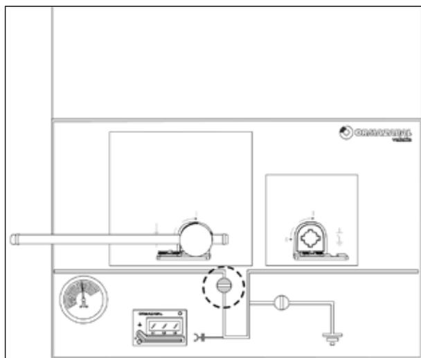
Рис. 5.30 Выключатель-разъединитель отключен
