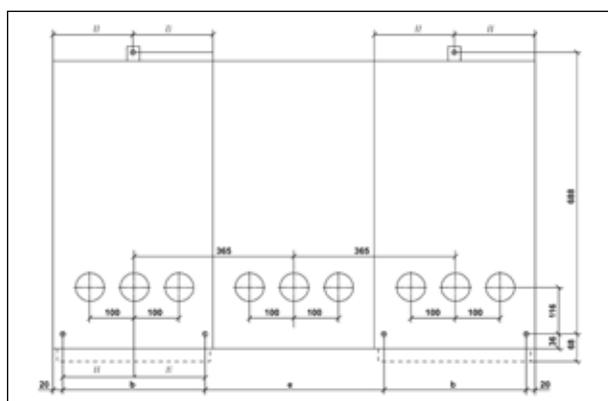
Рис. 4.29 Схема анкерного крепления **cgmcosmos-3I** высотой 1300 мм
