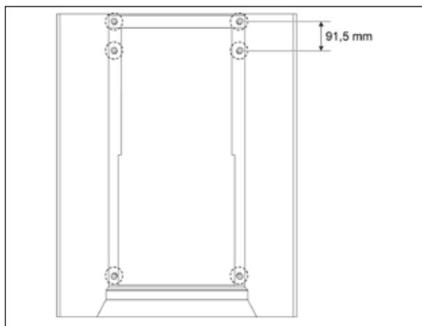
Рис. 4.37 Точки анкерного крепления для сейсмически устойчивого оборудования
