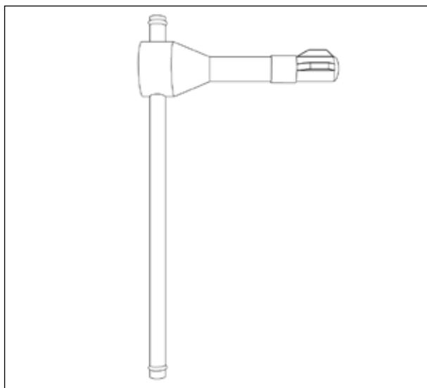
Рис. 5.24 Рычаг приводных механизмов В и ВМ
