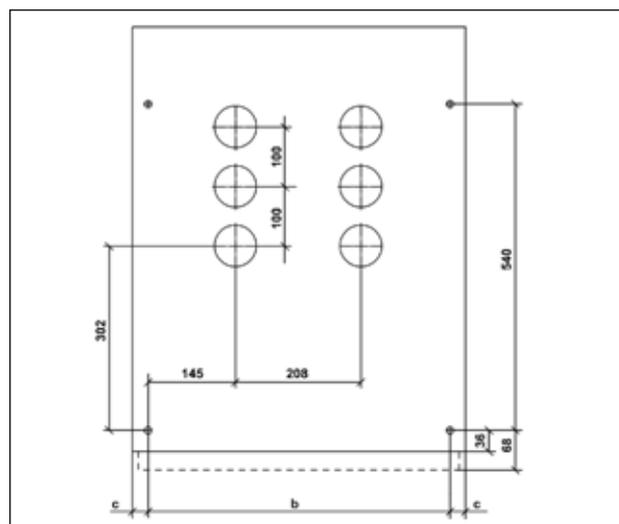
**Рис. 4.24** Схема анкерного крепления **cgmcosmos-r2c** высотой 1740 мм
