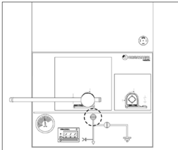
Рис. 5.14 Выключатель-разъединитель отключен
