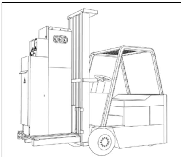
**Рис. 2.1** Подъем ячейки **cgmcosmos** вилочным погрузчиком
