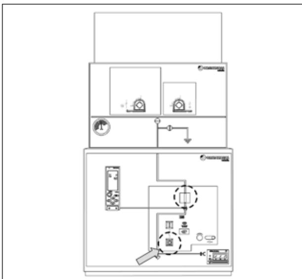
Рис. 5.73 Кнопка отключения
