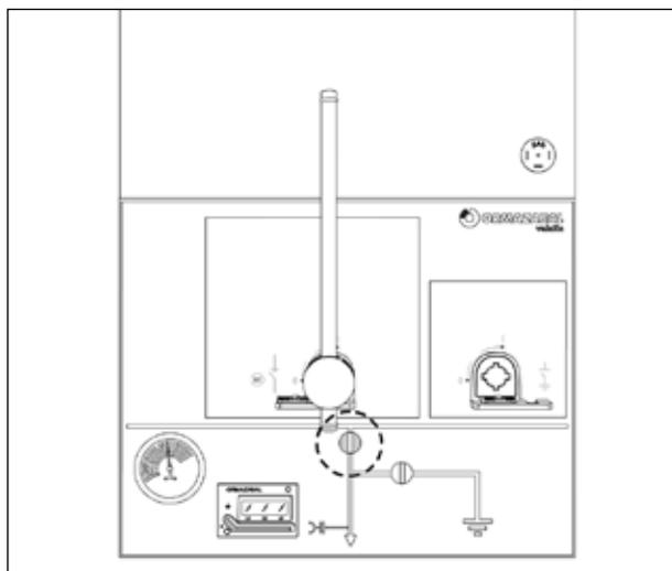
Рис. 5.12 Выключатель-разъединитель включен
