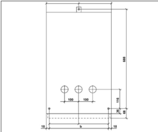
**Рис. 4.20** Схема анкерного крепления **cgmcosmos-v** с приводным механизмом AV3 высотой 1300 мм
