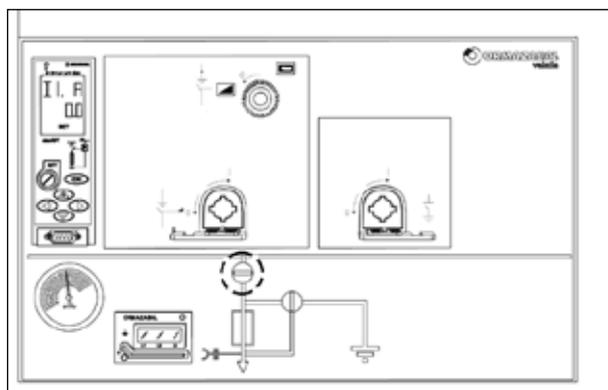
Рис. 5.47 Выключатель-разъединитель отключен
