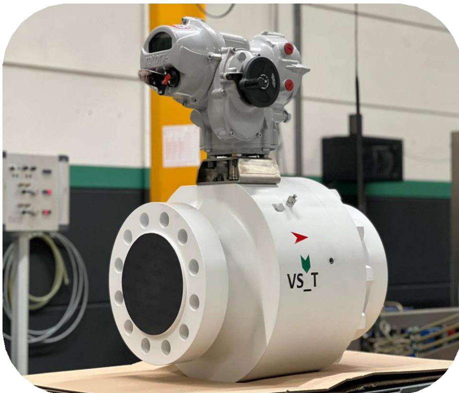
Robinet axial de reglare 6" Clasa 1500, A182 F 316 (Material forjat) Temperatura de proiectare: -50^{\circ}\text{C} \div +121^{\circ}\text{C} Aplicatii: Faza mixta – Hidrocarburi + H 2 O + (particule nisip)
