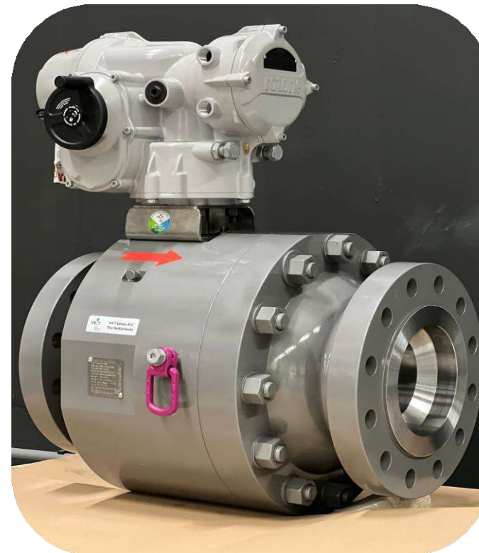
Robinet axial de reglare 8" Clasa 600, A350 LF2 (Material forjat) Temperatura de proiectare: -46^{\circ}\text{C} \div +121^{\circ}\text{C} Aplicatii: Faza mixta- Hidrocarburi (Combustibil)
