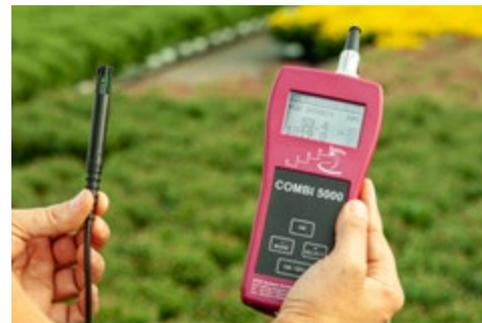
HPT-зонд позволяет одновременно измерять температуру, влажность и атмосферное давление воздуха. Встроенный датчик отличается высокой точностью и очень быстрой реакцией. Как и все зонды COMBI 5000, зонд температуры и влажности воздуха автоматически распознается с помощью специального кодирования, как только он подключается к основному прибору.
