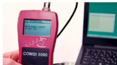
Основной прибор можно заказать с встроенным регистратором данных, который записывает все измерения. С помощью USB-кабеля все данные, хранящиеся в устройстве, могут быть переданы на компьютер.
