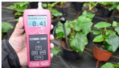
Прибор АМ 5000 определяет содержание растворенных солей в почвах или субстратах с учетом основных их характеристик, таких как влажность, температура и плотность. Принцип работы прибора основан на современной SMD-технологии, используемой во всех приборах серии 5000. Эта технология считается намного более надежной и наименее зависимой от температуры, чем все предыдущие.
