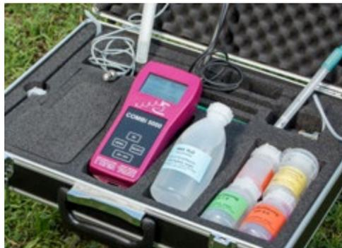
COMBI 5000 - это универсальный прибор для быстрого измерения самых важных параметров в производстве растений, таких как pH, ЕС, активность солей, температура и влажность почвы.
