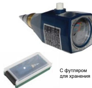
Прочный прибор для прямых измерений в полевых условиях с индикацией контроля влажности почвы.
