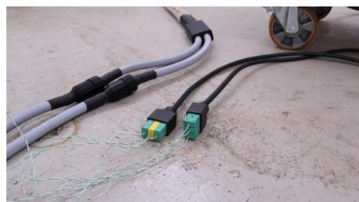
Все провода проложены в износостойком рукаве, что защищает их от повреждений.
