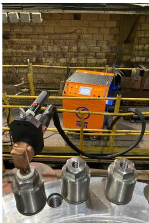
*Нагрев шпилек во время разборки и сборки корпуса паровой турбины*
