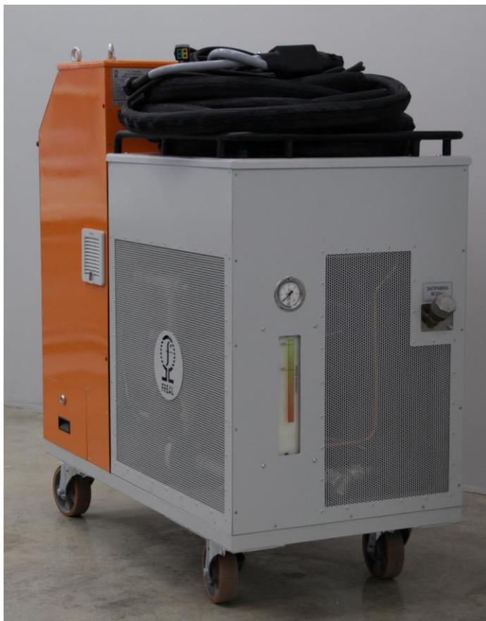
Мобильная установка смонтирована на раме с колесами из износостойкой масло- и бензостойкой резины, оснащенные тормозами, что позволяет ей легко перемещаться в производственных помещениях.
