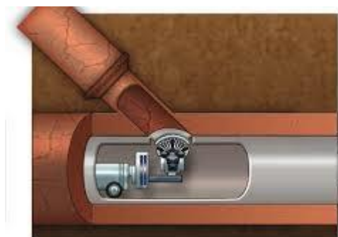
Dupa frezarea racordurilor(redeschideri) pe colector
