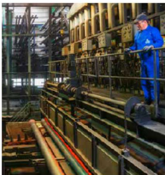
Cuptor de călire pentru îmbunătățirea proprietăților materialului
