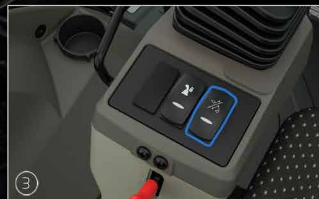
3 Кнопка переводного механизма для функции обратной лопаты или погрузчика
