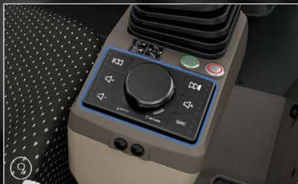
Кнопка управления интерфейсом Орега, встроенная в сиденье (**)
