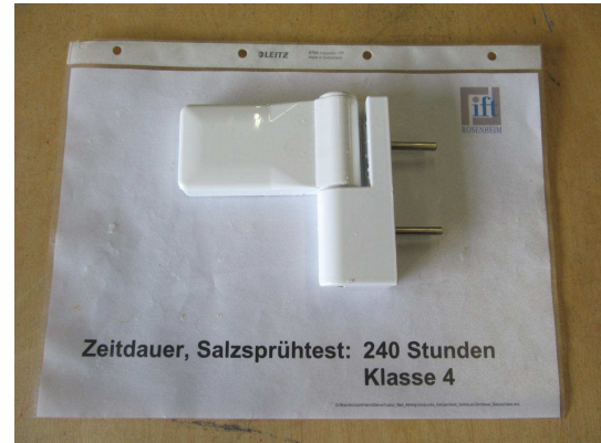
Bild 4 Ansicht Probekörper nach der Korrosionsprüfung
