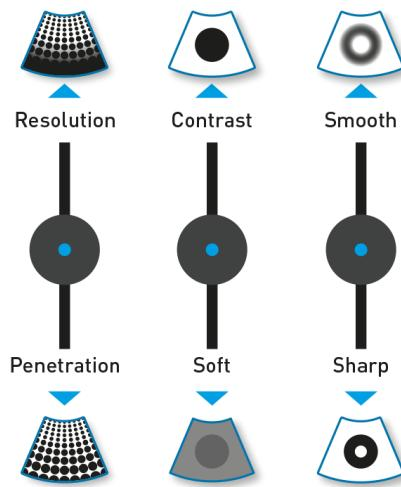
Нажатия клавиши **easyMODE** открывает меню с тремя ползунками, каждый из которых изменяет разные установки изображения, которые воздействуют в противоположной манере на изображение:
