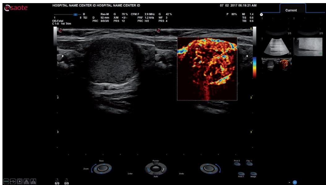
Клавиша **microV** активизирует/отменяет режим Микро - Васскуляризацию Изображения для того, чтобы расширить чувствительность к визуализации малых сосудов и определению кровотока с низкой скоростью. Когда нажата клавиша, она открывает закладку CFM с дополнительными функциями управления; обратитесь к разделу CFM за дополнительной информацией в этой инструкции.
