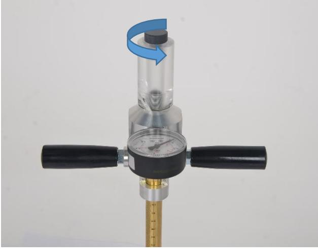
Figür 9: Tıkacın Çıkarılması için Saat Yönünün Tersine Çevrilişi
