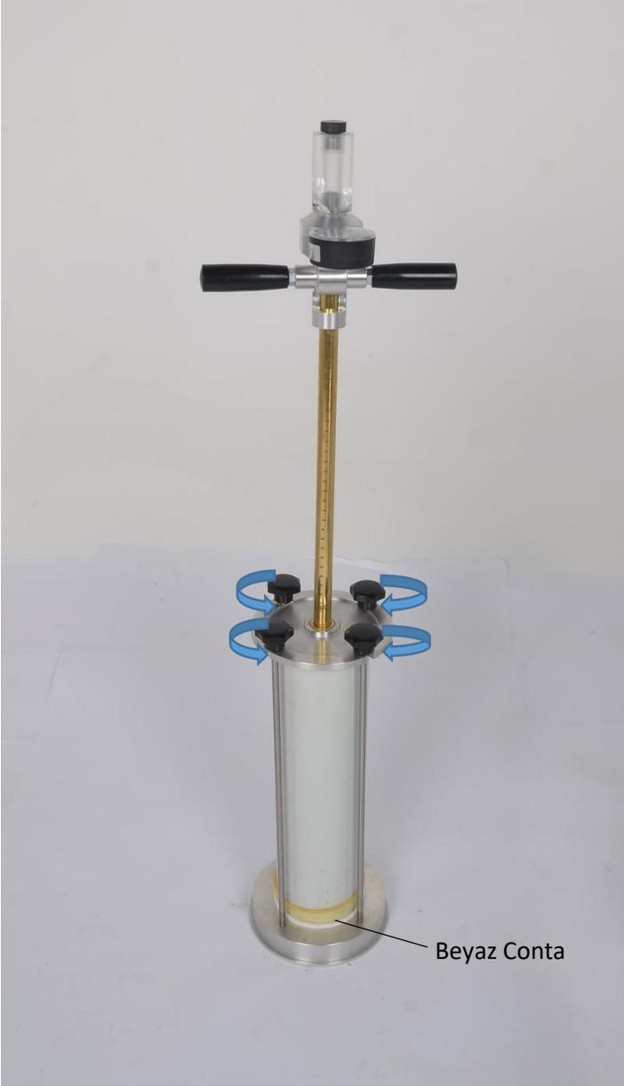
Figür 4: Su Dolumu için Hazırlanmış Dereceli Piston Mili
