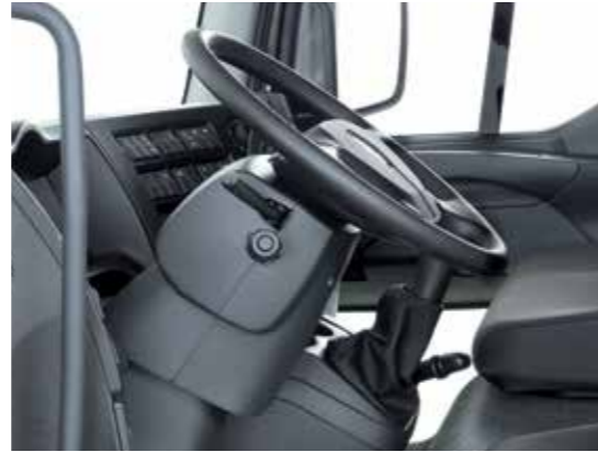
VOLAN REGLABIL ajustabil pe două dimensiuni.
