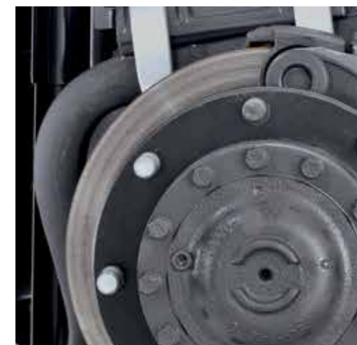
FRÂNE CU DISC permit o decelerare de 7 \text{ m/s}^2 pentru frânarea de urgență (standardul este de 4,5 \text{ m/s}^2 ).
