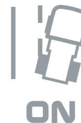
SISTEM DE AVERTIZARE DE DEPĂȘIRE A BENZII DE MERS Îl avertizează cu un semnal sonor pe conducătorul auto atunci când detectează o deviere involuntară a traiectoriei autovehiculului.
