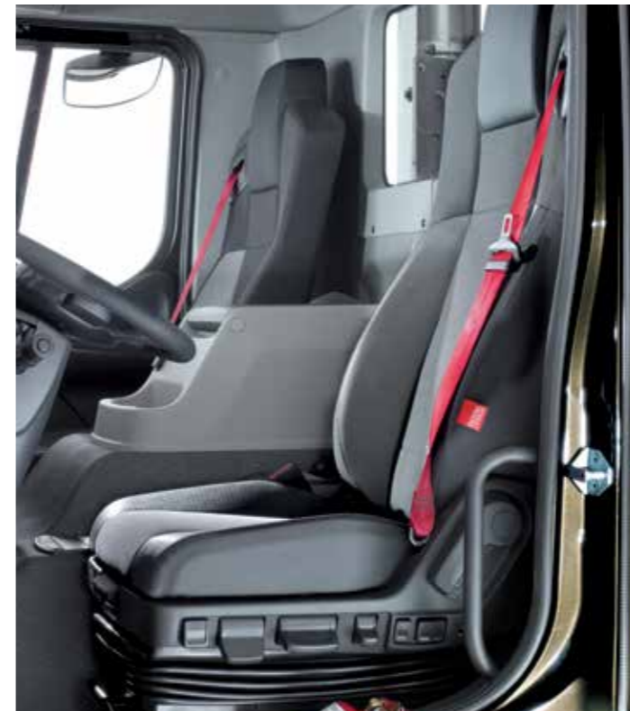
SCAUNE ÎNCĂLZITE ȘI PNEUMATICE suspendate, cu sprijin lateral și lombar reglabile.
