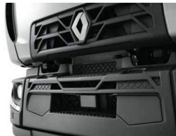
TREPTE DE ACCES LA PARBRIZ antiderapante pentru a facilita întreținerea autovehiculului.
