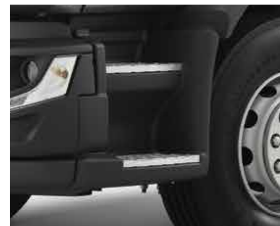
TREPTE DE ACCES TIP SCARĂ cu un spațiu retras de 80 mm între cele două scări pentru facilitarea accesului în cabină.
