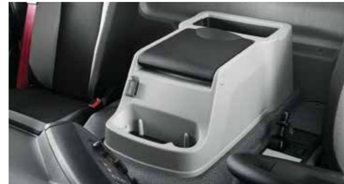
SPAȚIU DE DEPOZITARE CENTRAL cu o capacitate de 15 L, măsuță de scris, suport pentru sticle, suport de pahare, alimentare suplimentară de 24 V.
