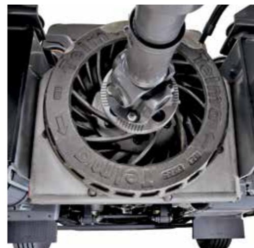
RETARDER ELECTRIC PE TRANSMISIE și hidraulic pe cutiile de viteze.
