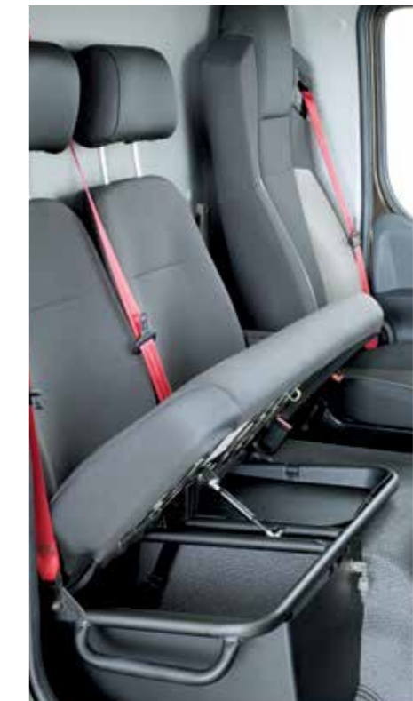
SPAȚIU DE DEPOZITARE SUB BANCHETĂ grație pernei care se poate ridica.
