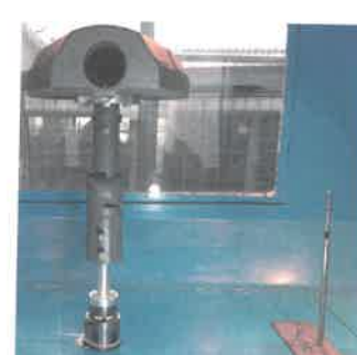
Fig. 11 – Corpul de iluminat montat în camera de experimentare a tunelului aerodinamic în poziția de încercare lateral orizontal ( \alpha_{xz} = 0^\circ ; \beta_{xy} = 90^\circ )
