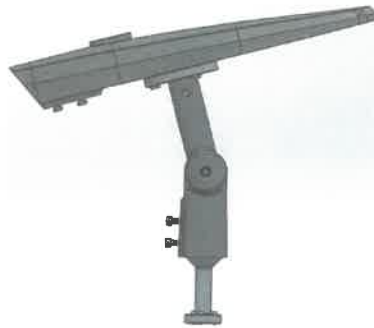
Fig. 15 – Modelul 3D al corpului de iluminat în poziția de încercare longitudinal ( \alpha_{xz} = 15^\circ ; \beta_{xy} = 0^\circ )
