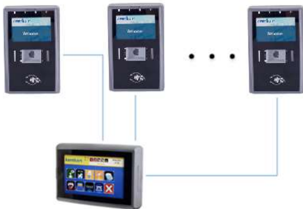
Figura 15. Conexiune multiplă a validatoarelor la o OBU
