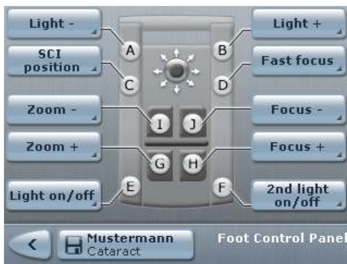
Fig. 62: Alocare preconfigurată a butoanelor panoului de comandă de picior
