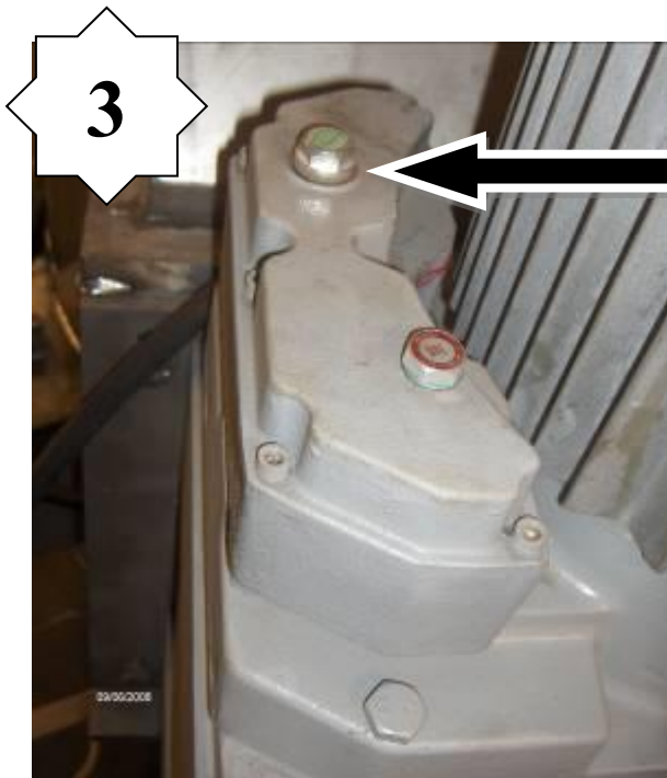
Plug of the extend oil box Bouchon du vase d'expansion d'huile
