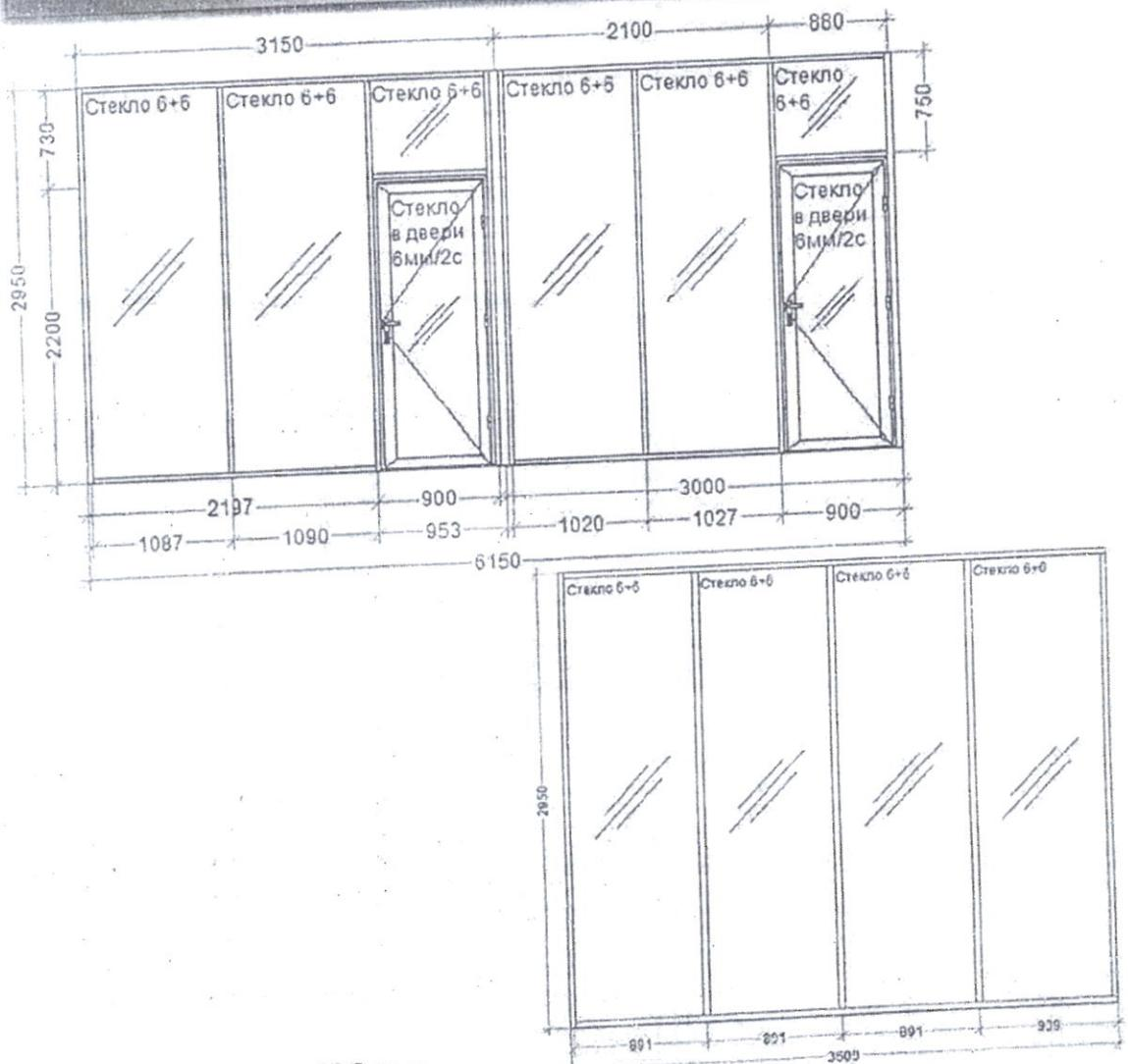
Размер конструкции : 28,8 кв. м.
