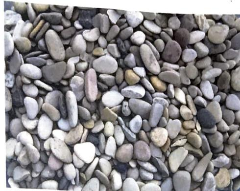
Pietriș de râu spălat spalat, fără argila și sedimente folosit ca suprafața de contact, fracție 5-20 cm.
