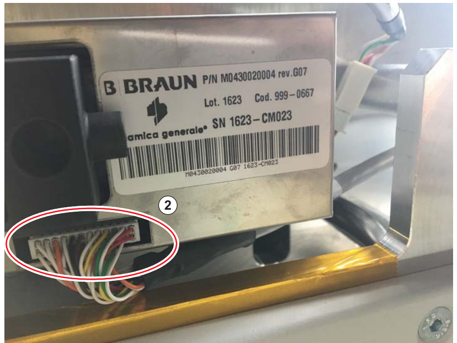
Fig. 5-141 Cable left load cell
