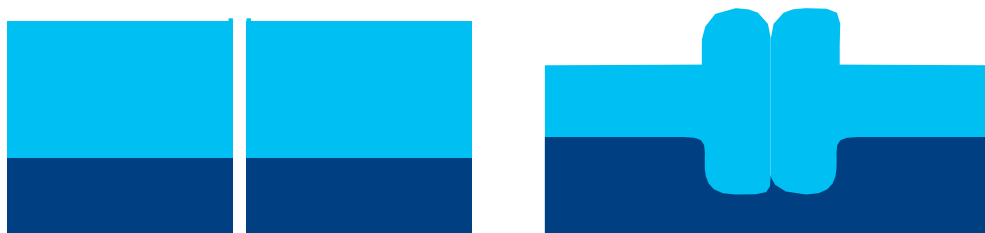
Alinierea și îmbinarea țevelor, sub presiune apar gulerașe
