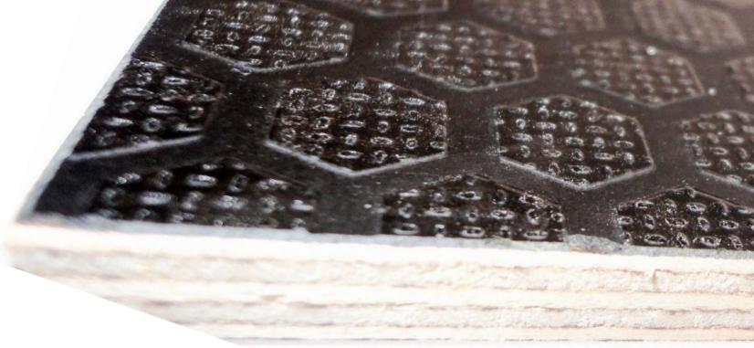
Das Sperrholz wird durch Aufbügeln auf das Laubsperrholz von speziellem Papier, welches mit Harz imprägniert wurde – diese Schicht wird umgangssprachlich Schicht mit dem „Honigwabe-Abdruck“ genannt, hergestellt.
