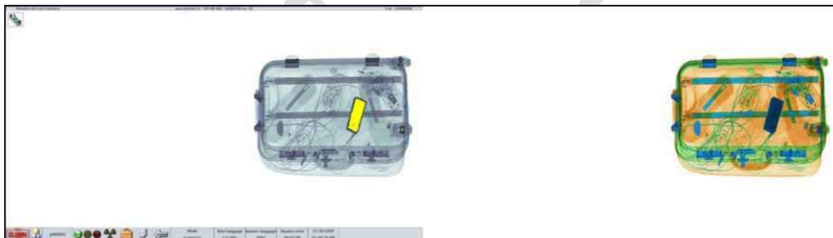
Figura 60 - Alarmă densitate bagaj
