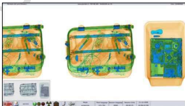
Figura 11 - Imagine tipică cu raze X pe 1 monitor afișată de către FEP ME 640: vizualizare color și alb-negru în miniatură
