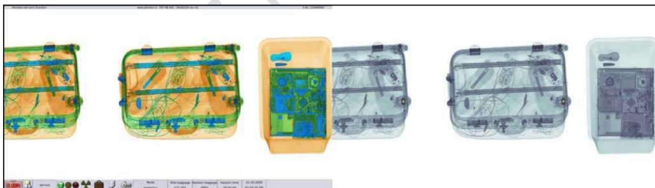
Figura 10 – imagine tipică cu raze X pe 2 monitoare afișată de către FEP ME 640: vizualizare color și alb-negru.
