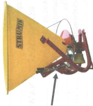
Rys.1 Usytuowanie tabliczki znamionowej rozsiwacza nawozów (dane identyfikacyjne)
