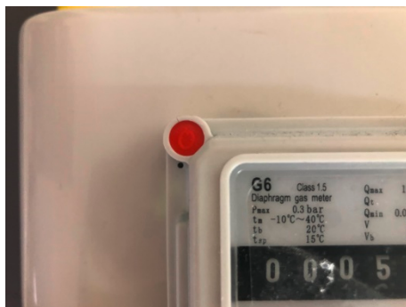
Immagine 3 - Sigillo metrologico per modelli da G1,6(ST) a G25(ST) in acciaio (con cover in PC trasparente)
