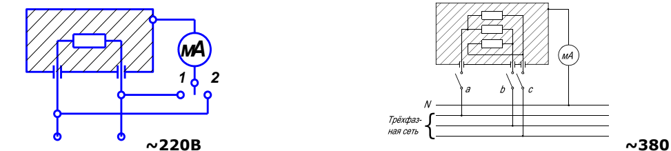
Рисунок 16 – Схема измерения тока утечки
