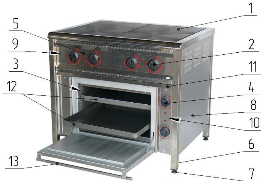
Рисунок 1. Загальний вигляд плити: 1 - конфорка; 2 - перемикач потужності конфорок; 3 - шафа жарова; 4 - датчик-реле температури; 5 - лампа сигнальна; 6 - захисний затискач (заземлення); 7 - опора регулююча; 8 - панель бокова; 9 - панель керування конфорками; 10 - панель керування шафою жаровою; 11 - піддон-жирозбірник; 12 - деко; 13 - ручка шафи жарової.
