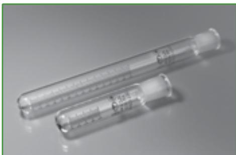
Цена деления, мл - 0,2. Толщина стенки, мм -  $1,4 \pm 0,2$ . Диаметр, мм: внешний - 17-18; внутренний - 14,4-15,2. Изготовлены из химико-лабораторного стекла по ГОСТ 21400-75. Упаковка 10 шт.
