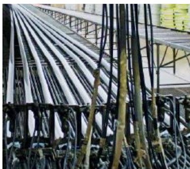
Furtunuri în timpul procesului de vulcanizare
