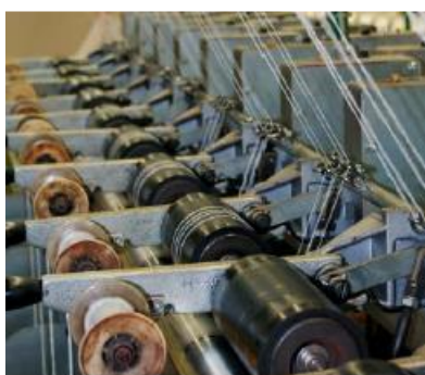
Proces de torsionare în urzeală și bătătură
