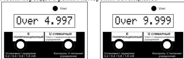
Рисунок 7.7 – Индикация порога перегрузки
