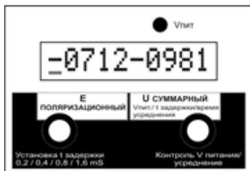
Рисунок 7.9 – Индикация режима экстраполяции потенциалов
