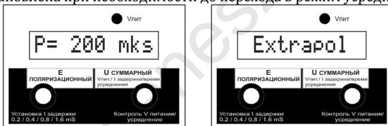
Рисунок 7.8 – Индикация времени задержки 200 мкс, выбор режима экстраполяции
