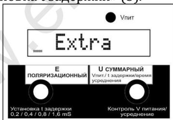
Рисунок 7.10 – Индикация готовности результата экстраполяции
