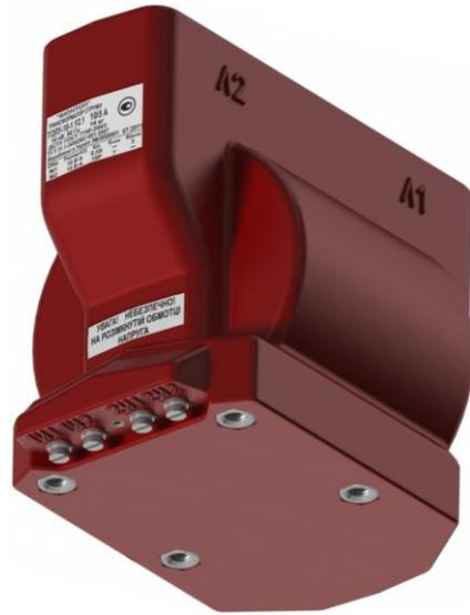
Трансформаторы тока ТОЛУ-10-1 предназначены для передачи сигнала измерительной информации измерительным приборам, устройствам защиты и управления, для изолирования цепей вторичных соединений от высокого напряжения в комплектных электрических устройствах внутренней установки (КРУ, КРУН, КСО) переменного тока на класс напряжения 10 кВ частотой 50 Гц.
