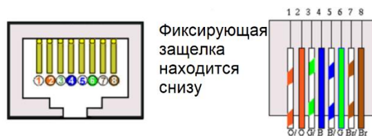
Рис. 5: Разъем (налево) и штекер (направо) системной связи
