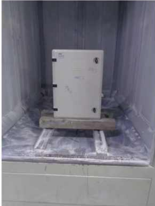
Tehlikeli Bölümlere Erişmeye ve Yabancı Katı Cisimlere Karşı Koruma Derecesi
