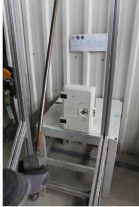
Dış Mekanik Darbelere Karşı Koruma Derecesinin Doğrulanması (Md. 9.5)
