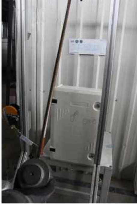
Dış Mekanik Darbelere Karşı Koruma Derecesinin Doğrulanması (Md. 9.5)
