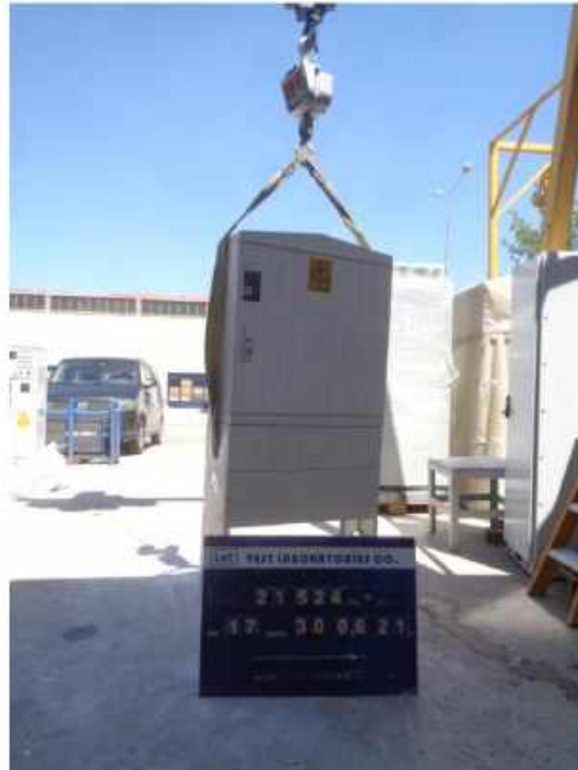
Kaldırma Deneyi (Md. 9.3)
