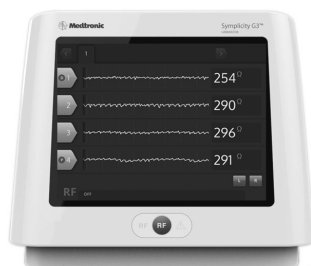
Joonis 2. Näidisilp neeruarterite denervatsiooni raadiosagedusgeneraatorist Symplicity G3™ impedantsi jälgimise kuvaga
