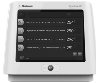
Figura 2. Imagine reprezentativă a generatorului RF pentru denervare renală Symplicity G3™ care afișează ecranul de monitorizare a impedanței
