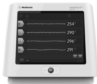
Рисунок 2. Типичное изображение РЧ-генератора для абляции почечных артерий Symplicity G3™ с экраном мониторинга импеданса
