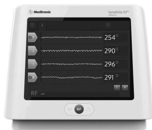
Figur 2. Exempelbild på Symplicity G3™ RF-generator för renal denervering, som visar skärmen för impedansövervakning
