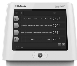
2. attēls. Nieru denervācijas RF ģenerators Symplicity G3™ ekrāna attēls, kurā redzams pilnās pretestības uzraudzības ekrāns
