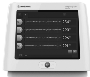
그림 2. 임피던스 모니터링 화면을 보여 주는 Symlicity G3™ 신장 신경차단 RF 발생기의 대표 이미지
