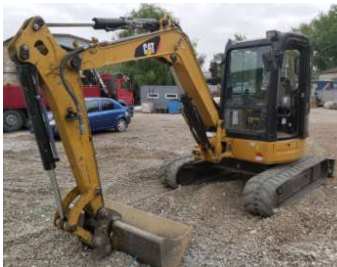
Figura 13. Vedere Nr.1 CAT-305 D
