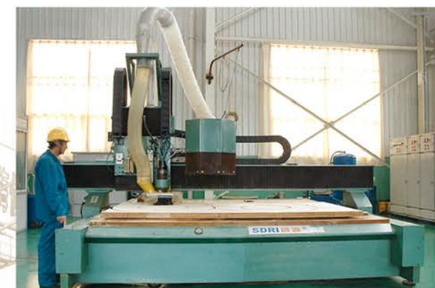
BXI-33绝缘件加工中心 BXI-33 Insulation Parts Processing Center
