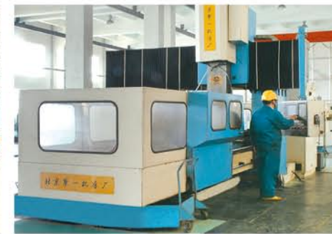
XHAD2412定梁龙门加工中心 XHAD2412Dinglianglongmen machining center
