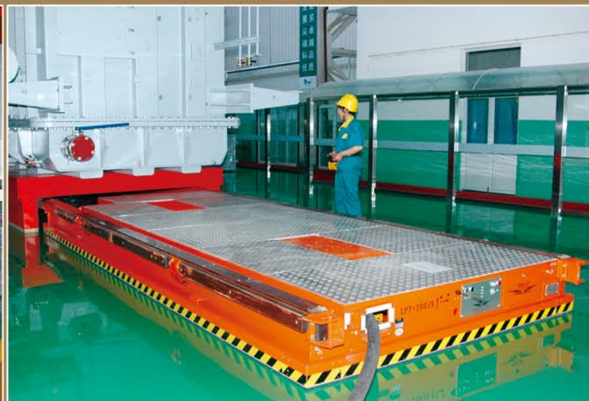
德国迪卢公司生产的LTS-560T气垫船 GRORG Dilu electric reduced LTS-5607 horvercraft
