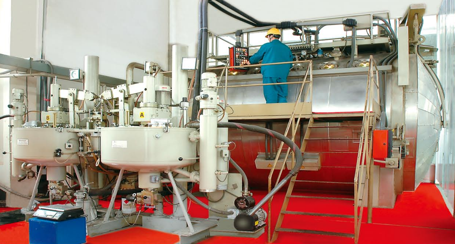
德国进口150/150-A-B.C大型真空浇注罐 150/150-A-B.C Giant Vacuum System(Germany)
