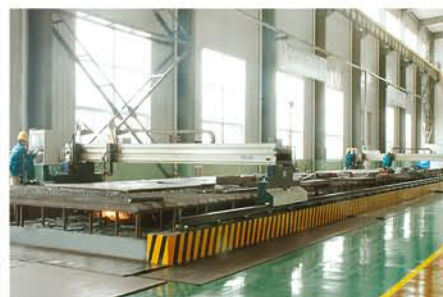
SZQG-II 数控火焰切割机绕线机 SZQG-II CNC Flame Cutting Machine
