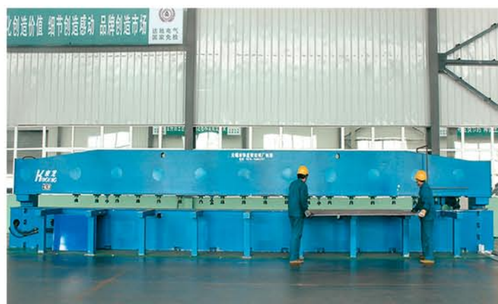
大型铣边机 large size edge miling machine
