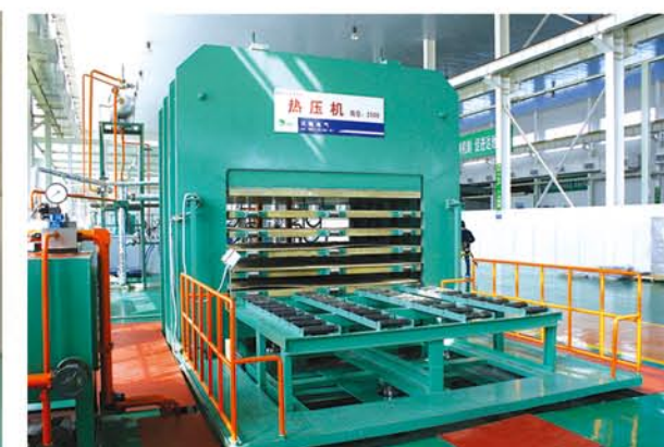
24000KN大型热压机 24000KN Giant Hot-press
