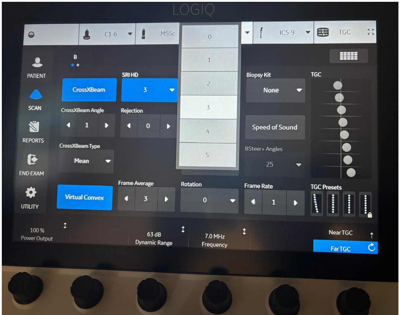
Fig. 2 SRI HD setarile LOGIQ Totus, imagine preluata de pe un sistem real. Nota la fel se observa ca setarile CrossXBeam se face de catre utilizator tot de pe ecranul tactil.
