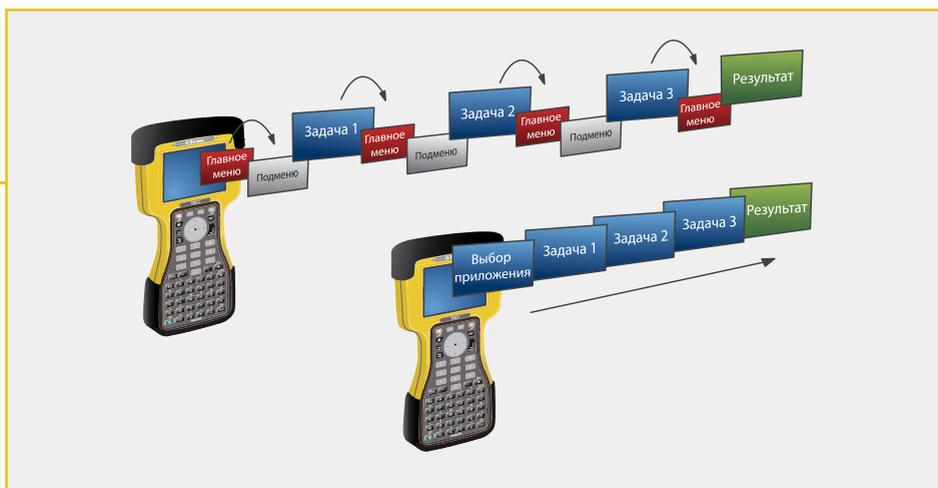
*Упрощенный порядок работы в ПО Trimble Access позволяет геодезистам сконцентрироваться не на управлении полевой программой, а на выполнении имеющегося проекта.*
