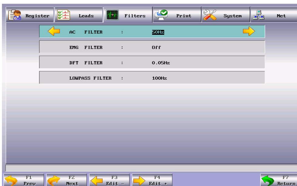
**Figura 5-6 Filter Options-Optiuni de Filtrare**
