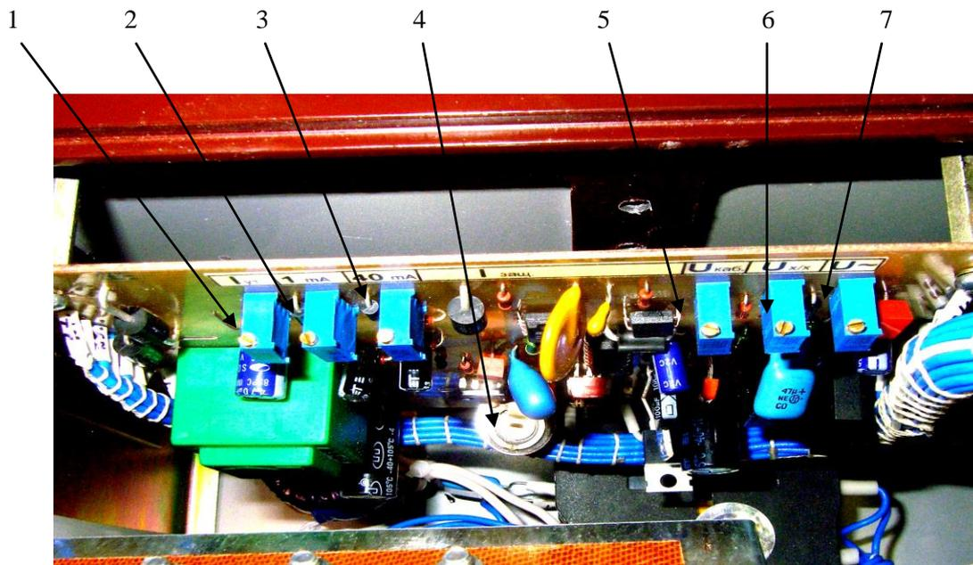
1. R28. “Iут” – регулировка тока утечки
