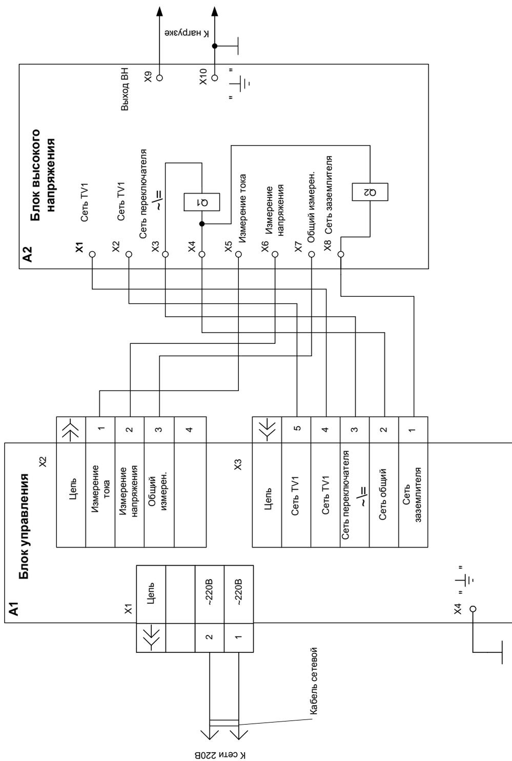
Рис. 4. Аппарат испытательный АВ-50/70. Схема соединений.
