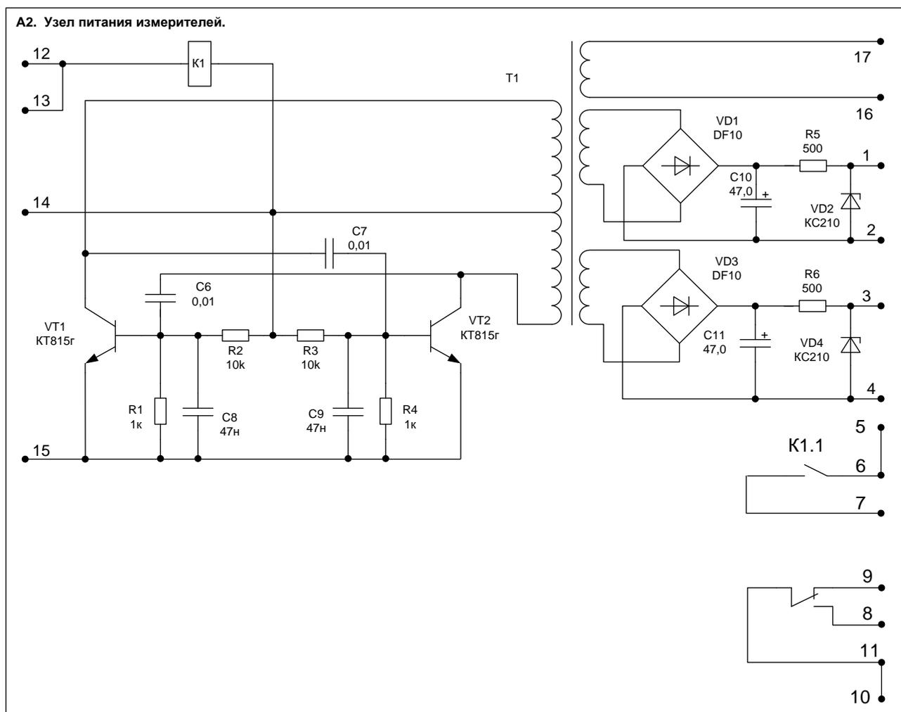
Рис. 6. Узел питания измерителей. Схема электрическая принципиальная.
