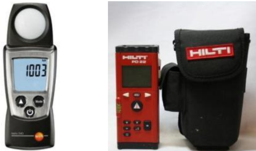
Figura 6 Instrumentele de măsură utilizate a) luxmetru TESTO și b) Laser metru HILTI
