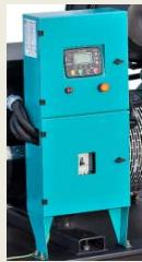
Панель управления электростанции с жидкокристаллическим буквенно-цифровым дисплеем и кнопками управления для контроля параметров внешней электросети и параметров электропитания от ДГУ, позволяет оператору взаимодействовать с установкой, выводит информацию о состояниях установки и внешней электросети
