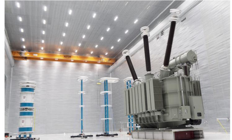
*Испытательная лаборатория ASTOR является крупнейшей в Европе и Турции. В нашей лаборатории, аккредитованной компанией TÜRKAK площадью 2200 м<sup>2</sup>, мы можем выполнить все стандартные, типовые и специальные испытания до напряжения 800 кв и уровня мощности 1000 МВА, за исключением испытания на механическое сопротивление короткому замыканию.*
