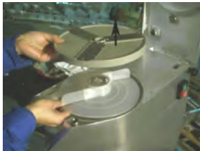
Instalación de lámina para cortar (4)
