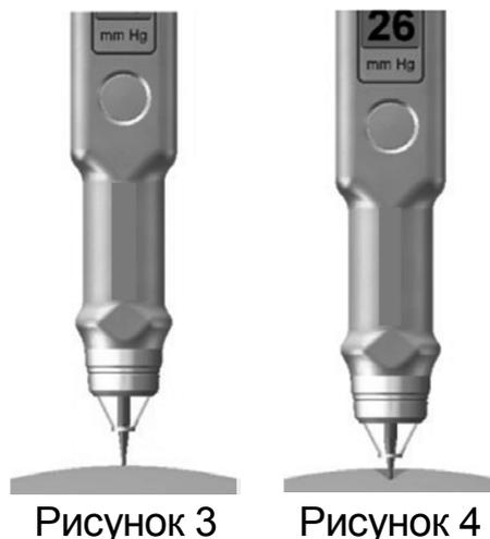
Через секунду после опускания - тонометр формирует звуковой сигнал о готовности измерения и выводит на дисплей измеренное значение ВГД. Измерение, однако, будет непрерывно продолжаться до поднятия прибора. Для завершения измерения необходимо плавно поднять прибор. Измеренное значение будет зафиксировано на дисплее до выключения прибора или до нового измерения. Выключение прибора производится кратковременным нажатием на кнопку включения.
