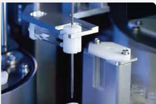
Технология промывки с обтирочным материалом Повышает эффективность и минимизирует примеси, переходящие в новый цикл
