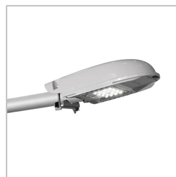
Reglare precisă la fața locului. Unghiul de înclinare poate fi setat de la -15° la +5° pentru montaj lateral și de la -10° la +10° cu ajutorul piesei de fixare pentru montaj în vârf de stâlp.
