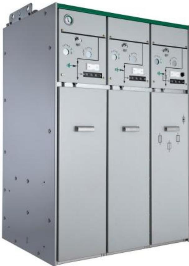
РУ-10кВ в элегазовой изоляции типа TGS - распределительное устройство среднего напряжения с газовой изоляцией SF6 на 12 или 24 кВ, 630 А, до 25 кА. Представляет собой устройство внутренней установки, состоящее из нескольких модулей, помещенных в герметичный резервуар из нержавеющей стали, наполненный газом с диэлектрическими свойствами SF6.
