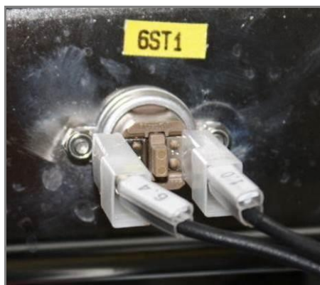
ALARM ! – 26 TEMP.SENS.FAILURE (CONTROL). ALARM! – 27 TEMP.SENS.FAILURE (RECORD)
