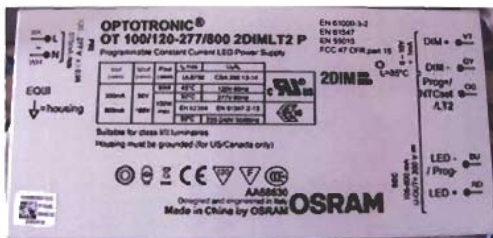
Zdroj s předřadníkem - Source and LED controller
