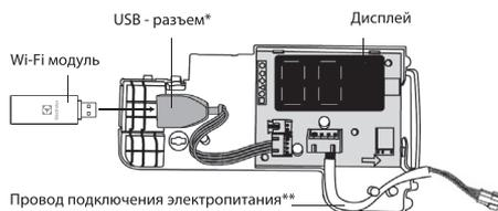
\* Разъем для подключения Wi-Fi модуля
